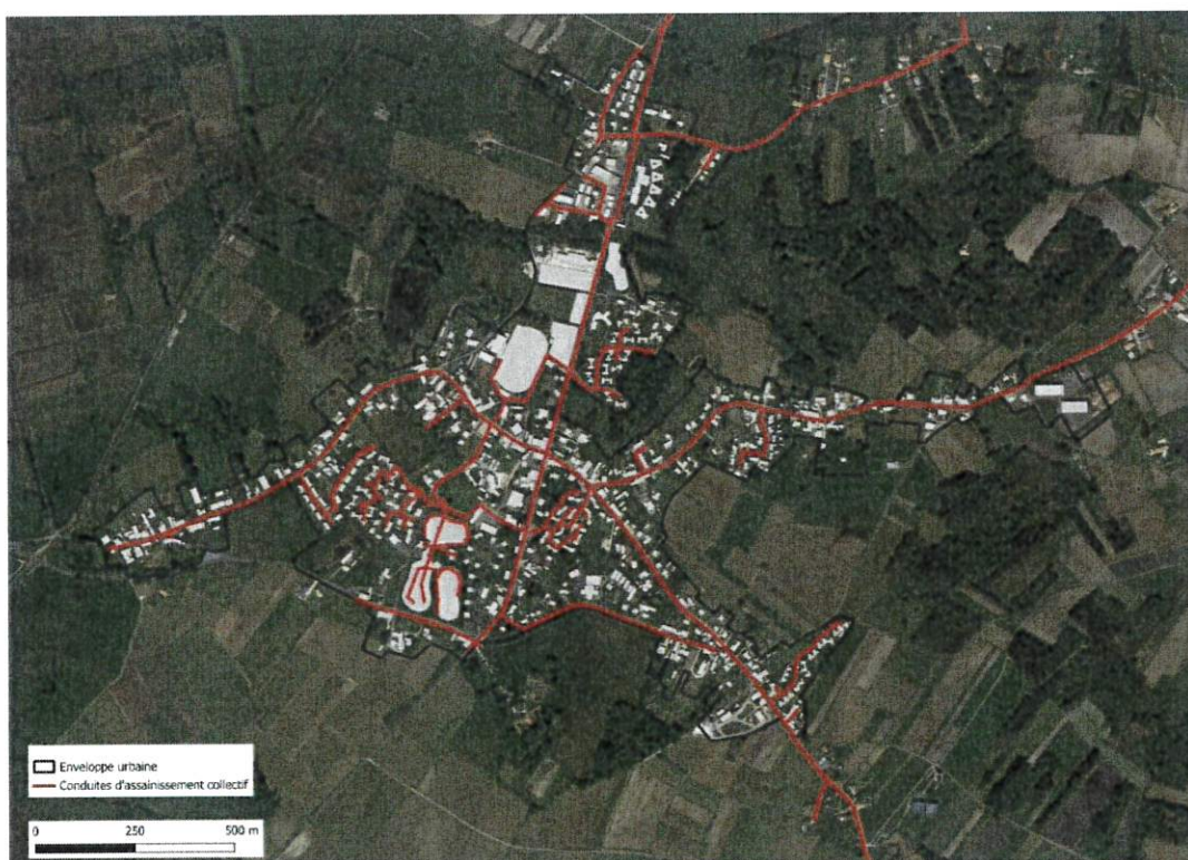
Les réseaux d'assainissement collectif (reliés à la station d'épuration située à proximité du camping au sud du bourg)
