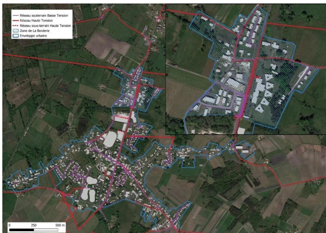
Les réseaux électriques Haute et Basse Tension
