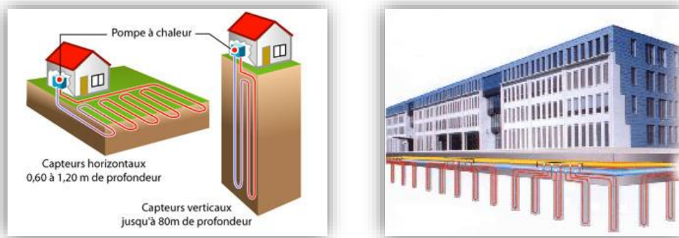
Figure 2 : Représentations de sondes géothermiques
