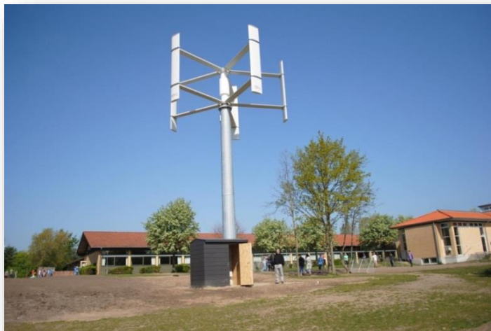
Eolienne à axe vertical Darrieus H de 6 kW
