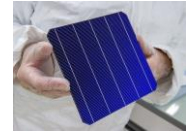
Cellule de 166 mm x 166 mm et d'épaisseur 0,1 mm
