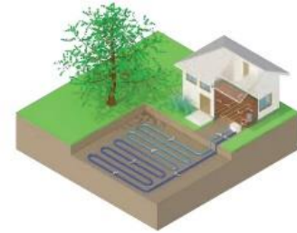
Capteurs horizontaux © geothermie-perspectives.fr, ADEME-BRGM
