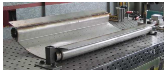
Canalisation préfabriquée avec échangeur de chaleur intégré (Guide pour les maîtres d'ouvrage et les communes, OFEN)
